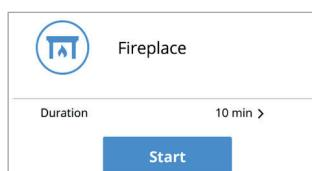
**Fireplace:** Detta är endast tillgängligt som ett tillfälligt läge med en inställd tid. Det är avsett för tillfällig användning tillsammans med en öppen spis. Det skapar ett övertryck i byggnaden för att underlätta att röken går ut genom skorstenen, vilket förhindrar att rök kommer in i byggnaden.
