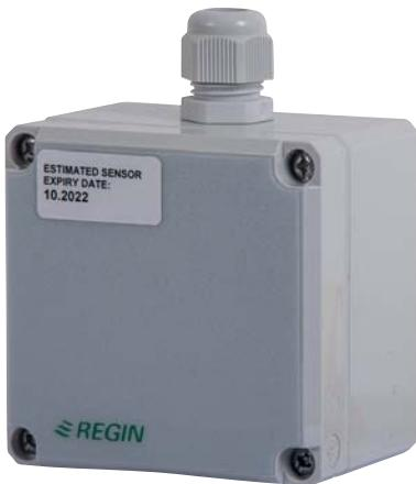
Lämplig montering av COF är i andningshöjd, omkring 180 cm ovanför golvet. En detektor ska placeras per 200-500 kvadratmeter garageyta, förutsatt att ytan är öppen (utan "fickor") och att man har kontinuerligt luftflöde. Förekommer "servicegropar" bör en COF installeras i varje grop. Transmittern ska monteras med kabelanslutningen uppåt.
