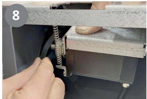
9. Skru ut skruene (2 stk.) til rotor-motoren. **TIPS:** Legg merke til hvilke hull som er benyttet. Ny rotormotor må festes i de samme hullene. (Gjelder kun Nordic S4.)
